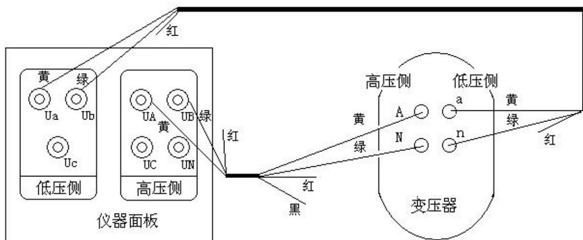
图十九、单相变压器的测试接线
