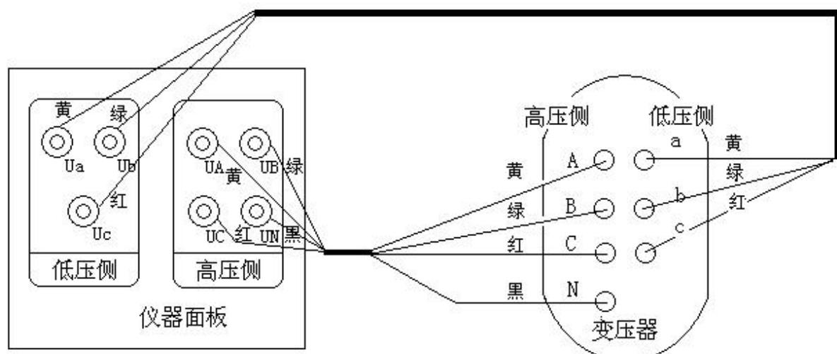
图二十、Z 型变的测试接线
